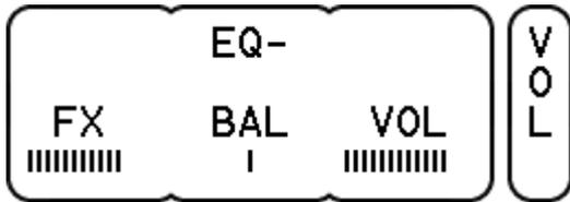
**EQ** Mit dieser Funktion können Sie festlegen, ob das Signal des ausgewählten Drum-Channel durch den EQ (siehe Seite 38) geschickt wird (**EQ+**) oder nicht (**EQ-**). Diese Funktion steht nur zur Verfügung, wenn auf der EQ-Page der Wert „Drum“ bei BUS eingestellt ist.
