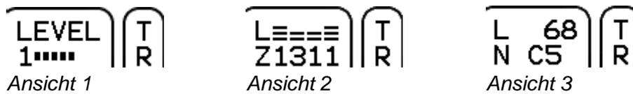
**Ansicht 1** Die Ziffer gibt an, welche Zone aktuell getriggert wurde. Die grafische Darstellung zeigt die Signalstärke an. Während des Triggerns wird zusätzlich in der ersten Zeile der dB-Wert des Signals eingeblendet.
